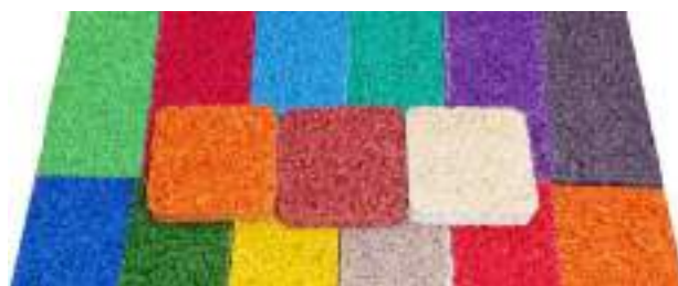
Илл. 1.1.11. ЦВЕТНЫЕ EPDM-ГРАНУЛЫ ДЛЯ ИЗГОТОВЛЕНИЯ РЕЗИНОВОГО ПОКРЫТИЯ
